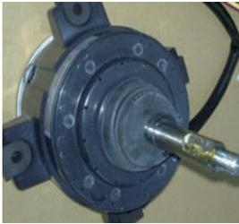
Estrutura do motor do ventilador DC
