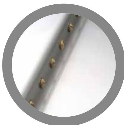
Sistema de lavagem da zona de trabalho Cleaning system for work surface with water jets
